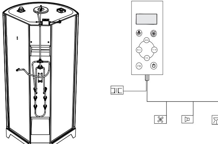
9. Установите кабину согласно схеме подводки воды и электричества. Обратите внимание, что подводка электричества осуществляется значительно выше чем подводка воды – это очень хорошо видно на рисунке.
