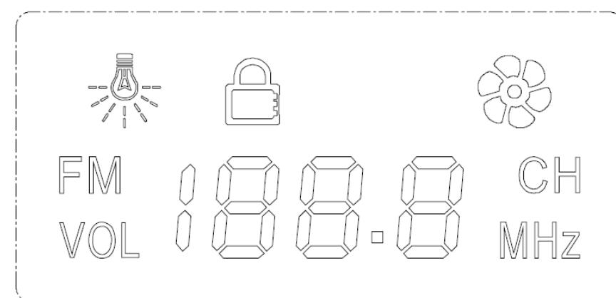
Пульт имеет специальную защиту и блокируется каждый раз когда Вы его не используете. При блокировке на дисплее появляется символ "замок". Блокировка производится автоматически через 180 секунд после последней операции с пультом. Разблокировка производится нажатием на любую кнопку устройства.
